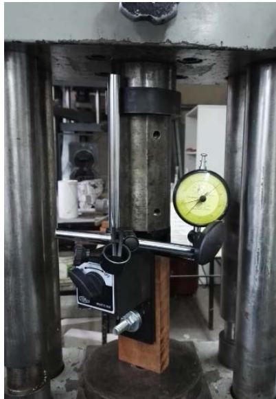
Figura 13 – Celda de carga – Ensayo de aplastamiento
