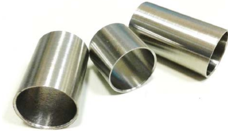
Figura 13. Acoples sin costura fabricados por el grupo de trabajo del IFIR mediante el método de extrusión por punzonado en caliente 54 .
