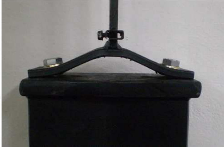
Figura 16 – Pieza de ensayo P2, fin de ensayo (sin rotura de bulones)
