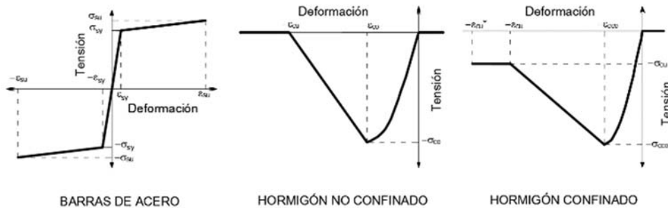
Figura 8. Modelos constitutivos para materiales en fibras de columnas
