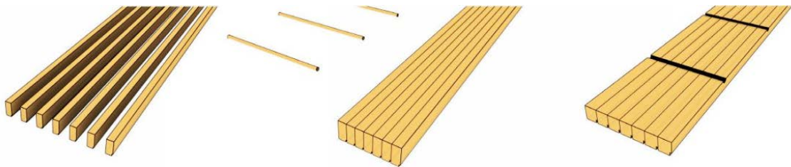
Figura 4. Proceso de fabricación de un panel de DLT
