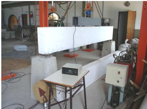
Figura 14-Laboratorio de Estructuras - Configuración e Instrumental para medición carga aplicada en ensayos de vigas Serie B ( a la izquierda) y C ( a la derecha)
