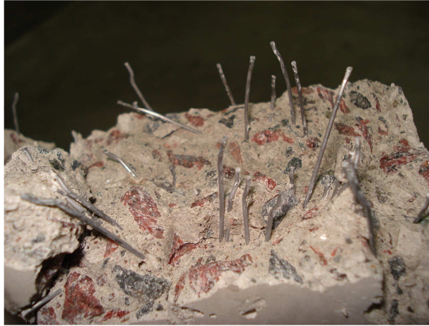
Figura 13 – Vista del plano de fractura, ensayo probetas prismáticas Serie B, con 60 kg/m 3 de fibras de acero
