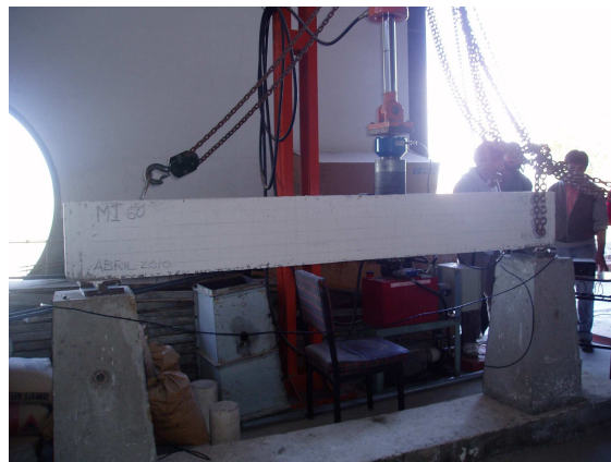
Figura 14-Laboratorio de Estructuras - Configuración e Instrumental para medición carga aplicada en ensayos de vigas Serie B ( a la izquierda) y C ( a la derecha)
