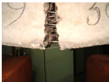
Figura 12 – Plano de fractura, ensayo probetas prismáticas Serie B, con 60 kg/m 3 de fibras de acero en la prensa INSTRON
