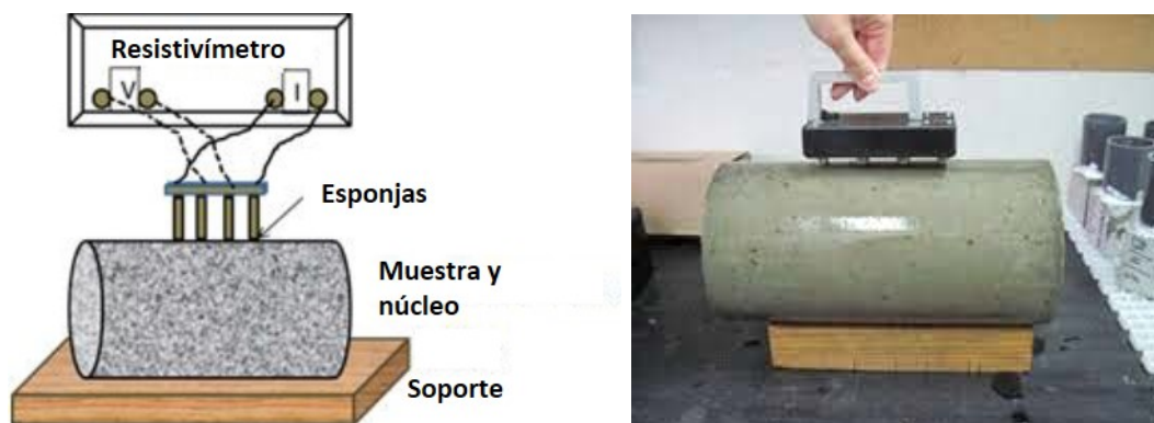
Figura 6. Esquema de la configuración del ensayo UNE 83988-2 9, 7
