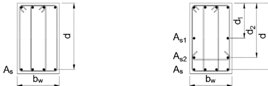
Figura 6. Sección transversal para determinar armadura longitudinal efectiva
