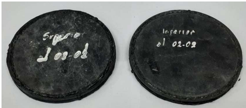
Figura 13: Disco rotado superior e inferior, vista de su cara en contacto con la probeta, luego de 150 usos.
