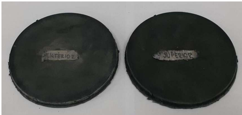
Figura 12: Disco fijo superior e inferior, vista de su cara en contacto con el disco de contención, luego de 150 usos.
