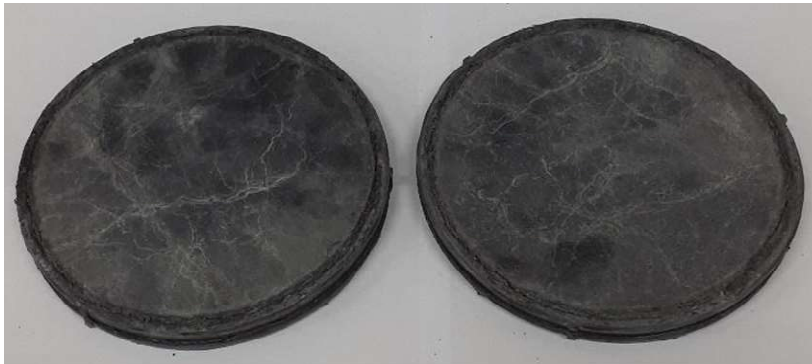
Figura 15 Disco rotado e intercambiado superior e inferior, vista de su cara en contacto con la probeta, luego de 150 usos.
