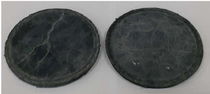
Figura 11: Disco fijo superior e inferior, vista de su cara en contacto con la probeta, luego de 150 usos.
