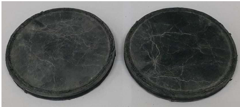
Figura 16: Disco rotado e intercambiado superior e inferior, vista de su cara en contacto con el disco de contención, luego de 150 usos.
