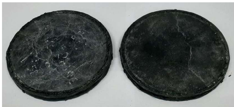
Figura 14: Disco rotado superior e inferior, vista de su cara en contacto con el disco de contención, luego de 150 usos.
