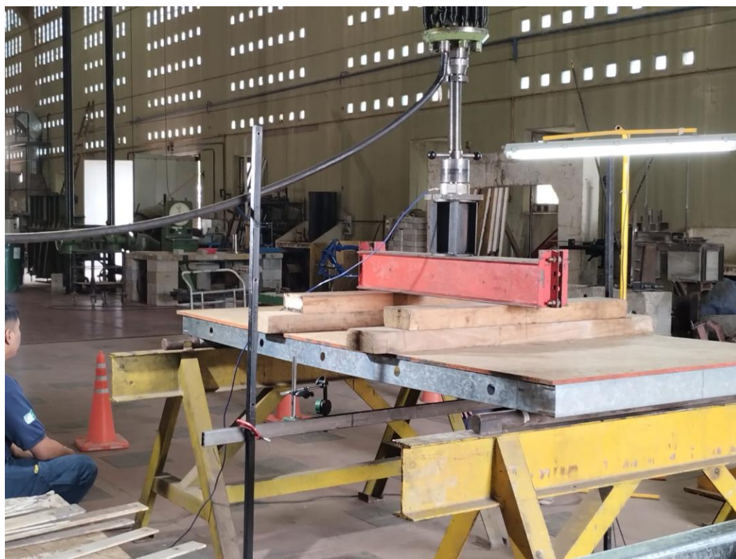
Figura 2. Dispositivo de ensayo con PGVS 89x0.9 y tornillos cada 20 cm. L= 2.44m
