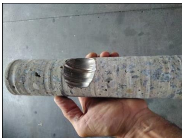
Figuras 27. Extracción de testigos con interferencias
