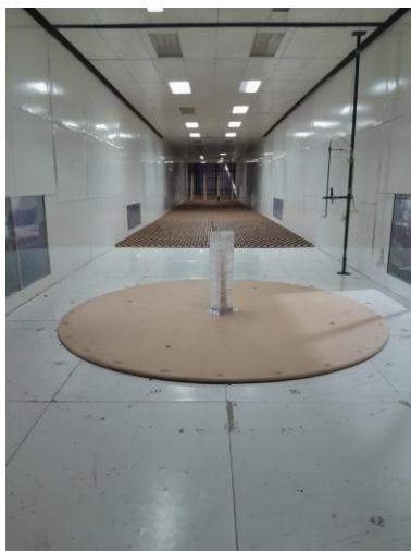
Figura 3. Modelo del edificio CAARC situado en la cámara de ensayos.
