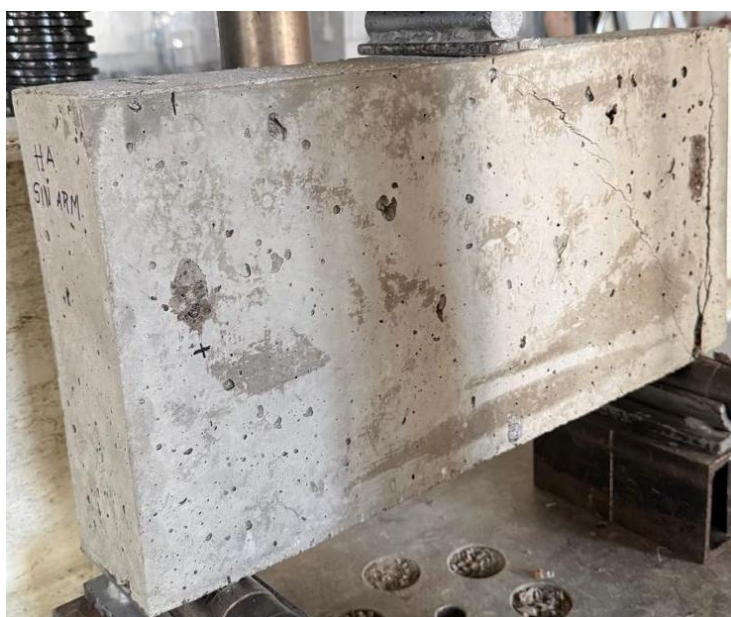
Figura 6. Modo de falla espécimen V-SA
