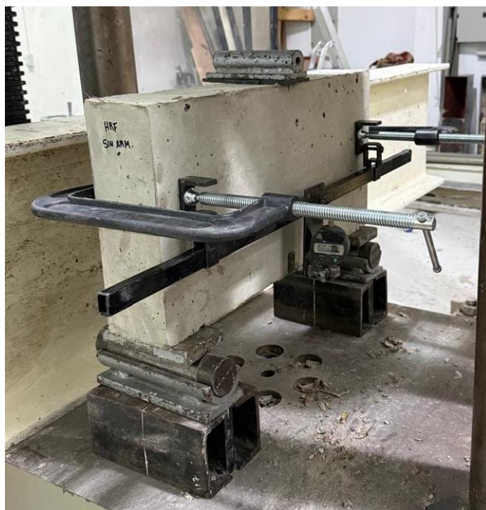
Figura 5. Ensayo a flexión en 3 puntos de VGA.
