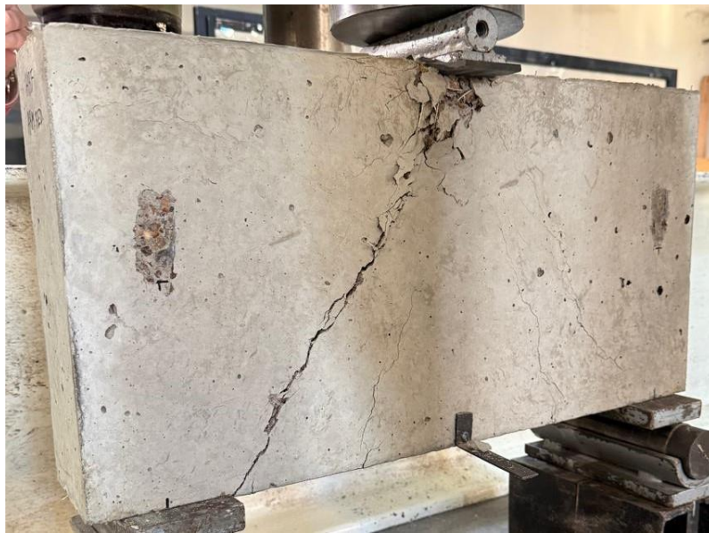
Figura 9. Modo de falla espécimen V-SA-HRFH
