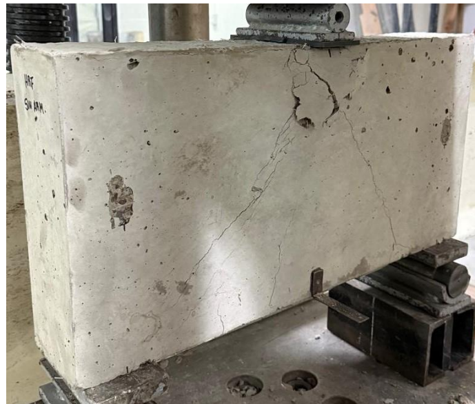
Figura 10. Modo de falla espécimen V-AR-HRFH.
