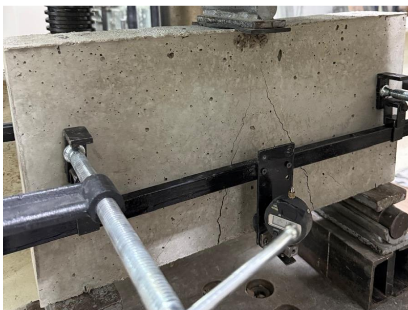
Figura 8. Modo de falla espécimen V-CA
