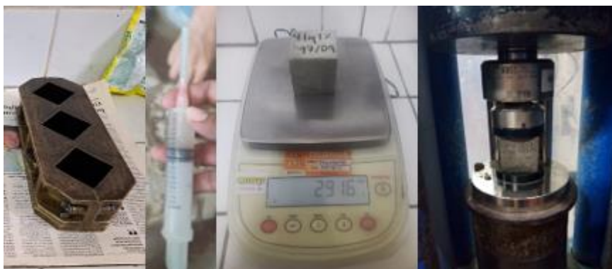
Figura 5. Proceso de elaboración de muestras y posterior ensayo a compresión.
