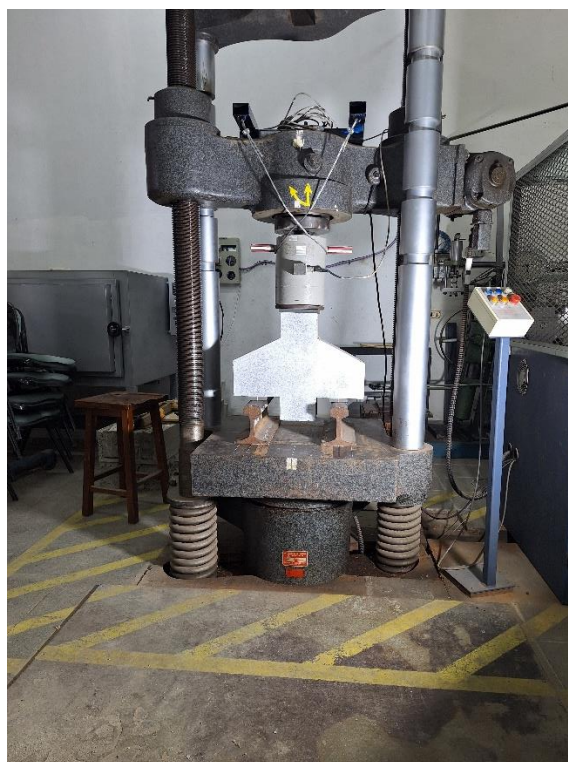
Figura 3. Ménsula en pórtico de carga
