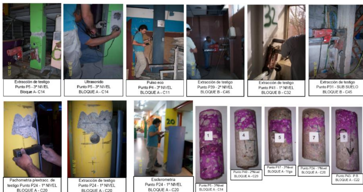
Figura 5. Relevamiento fotográfico de algunos ensayos estructurales realizados.
