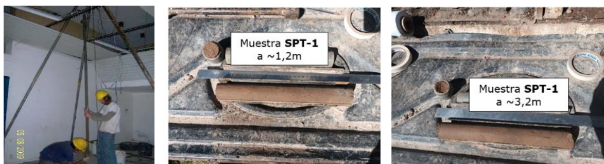
Figura 8. Fotografía del sondeo SPT-1 en el Bloque C y vista de algunas muestras.
