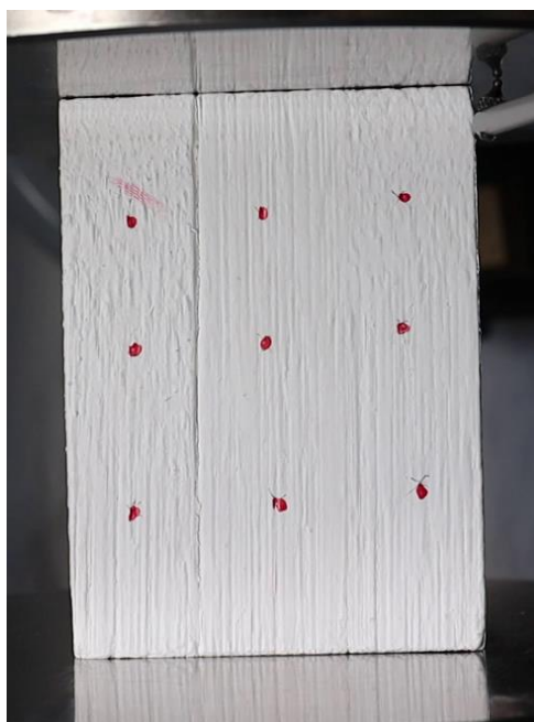
Figura 2. Probeta de CCLBT3 tratada para el análisis por la metodología DIC. Fuente: Elaboración Propia.
