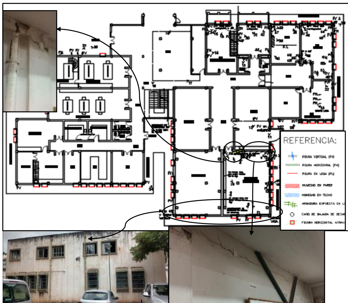
Figura 5. Relevamiento de daños
