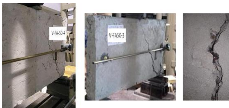
Figura 6. Modos de falla de las VGA de HRFA
