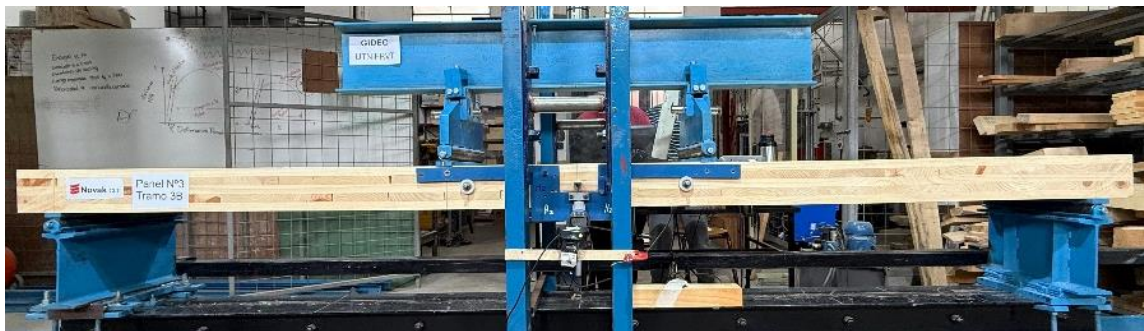
Figura 1. Ensayo a flexión fuera del plano en el marco de cargas del laboratorio GIDEC, UTN FRVT.
