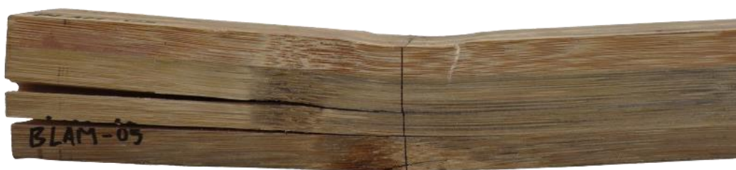
(c) Mecanismo de falla experimental
