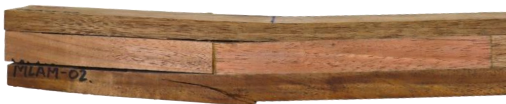
(c) Mecanismo de falla
