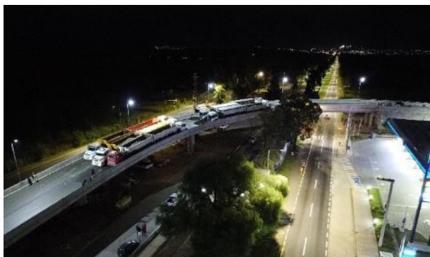
Figura 22. Etapa 5 Ubicación de 12 camiones en vanos 2 y 3- Carga máxima
