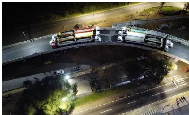
Figura 22. Etapa 5 Ubicación de 12 camiones en vanos 2 y 3- Carga máxima
