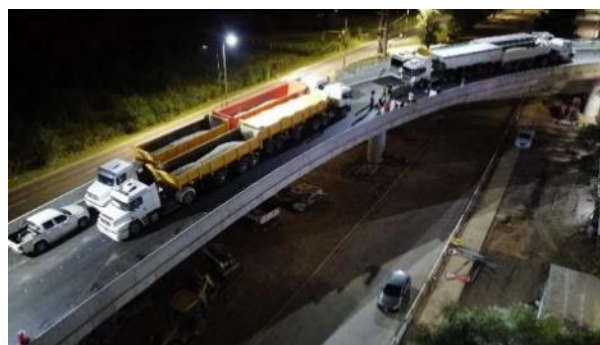
Figura 23. Etapa 6 Ubicación de 8 camiones en vanos 2 y 3-Carga excéntrica
