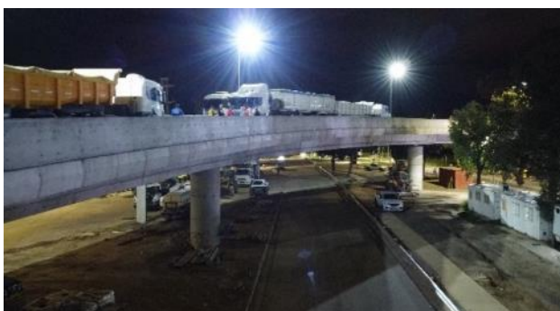
Figura 23. Etapa 6 Ubicación de 8 camiones en vanos 2 y 3-Carga excéntrica
