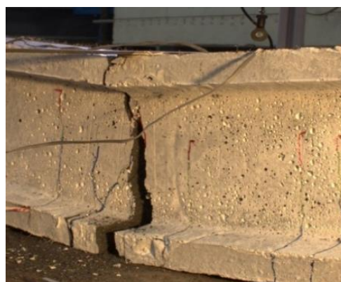
Figura 9 – Modos de fallo vigas S0 y S1 para la dosificación C3 .
