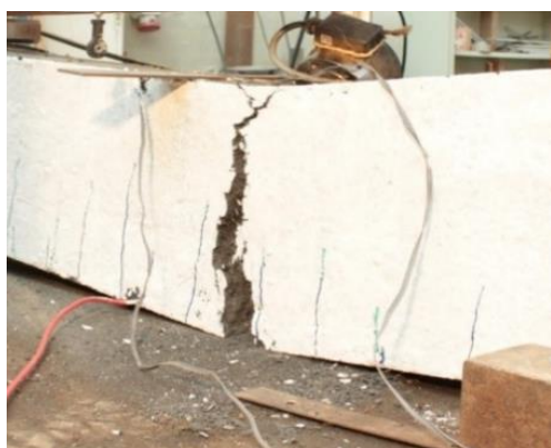
Figura 9 – Modos de fallo vigas S0 y S1 para la dosificación C3 .
