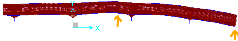
Figura 31. Deformación lateral del tablero (gráfica de medio puente ) – 150 kg/m 2 – Indicación con flechas ubicación junta en estribo y 1era junta Gerber Lado Rosario Giro relativo entre dos partes del apoyo en el estribo: 0°0'33".
